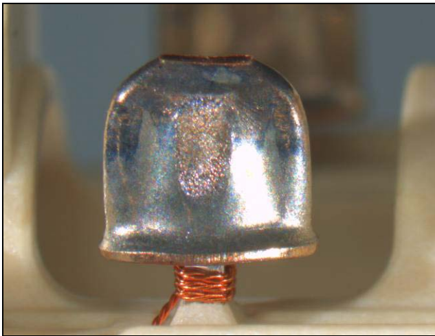
Bild 3. Anwendung Schweißen Kupferlackdrähte - Lackisolierter Kupferdraht an Vierkantstift. Drahtdurchmesser 70µm.
